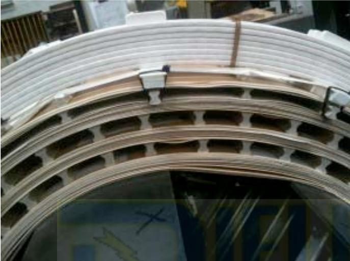
grazie alla sorprendente flessibilità e alla resistenza alla temperatura (220°C) **DielettrikFlex** sono i materiali più idonei per l'isolamento del nucleo, formazione di cilindri e pezzi lavorati
